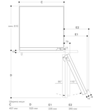
На чертеже взяты за основу размеры при толщине фронтальной панели 19 мм и высоте мебельной ручки Gaggenau 49 мм.
