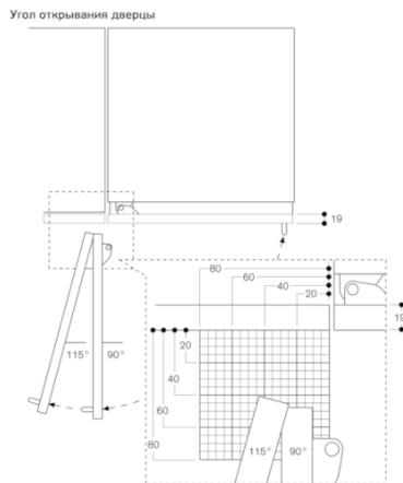
Данные о расстоянии до соседней мебели и её ручек с учётом размеров петель двери, расстояния, проходимого при её открывании, и толщины фронтальной панели даны на чертеже. На чертеже указаны размеры при толщине фронтальной панели 19 мм.
